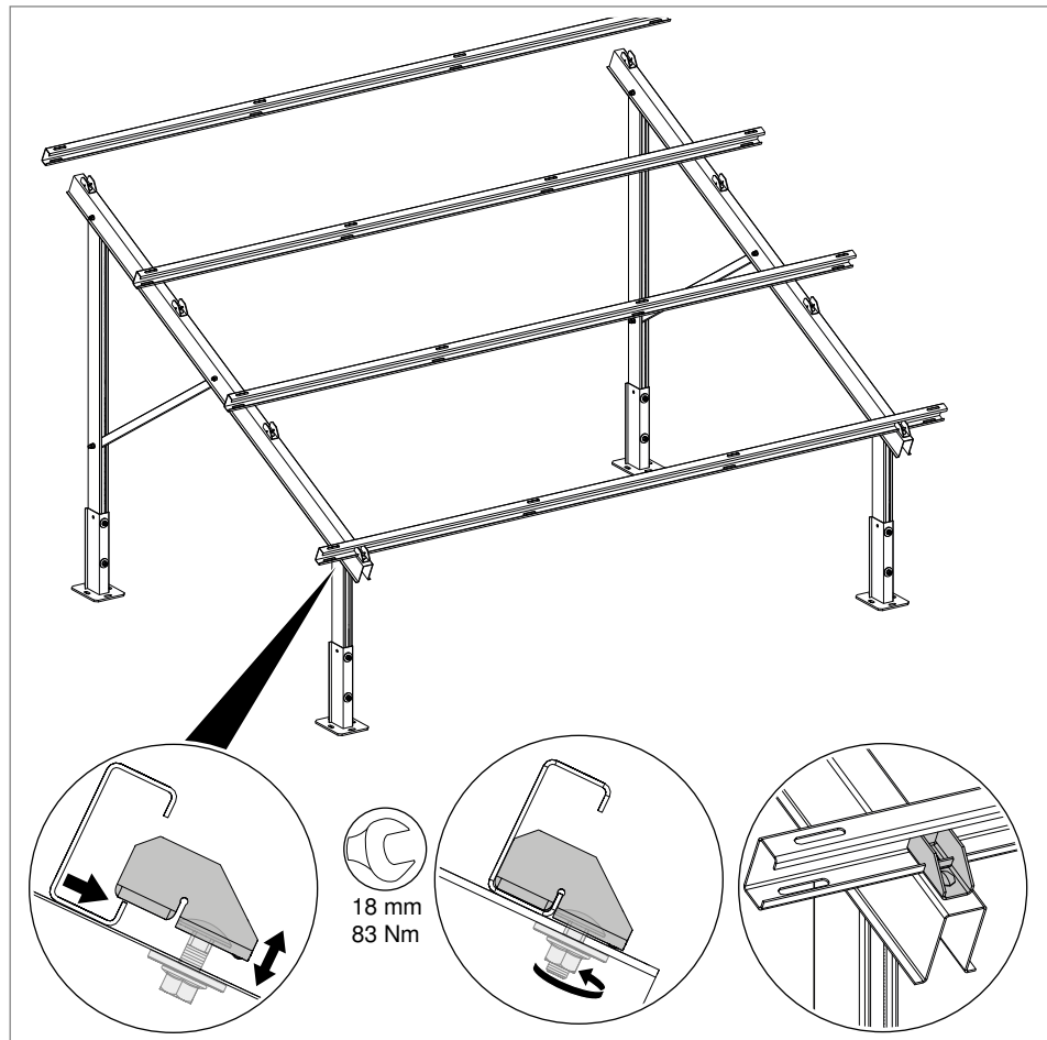
Abb. 15: Trägerprofile mit Kreuzverbindern montieren
